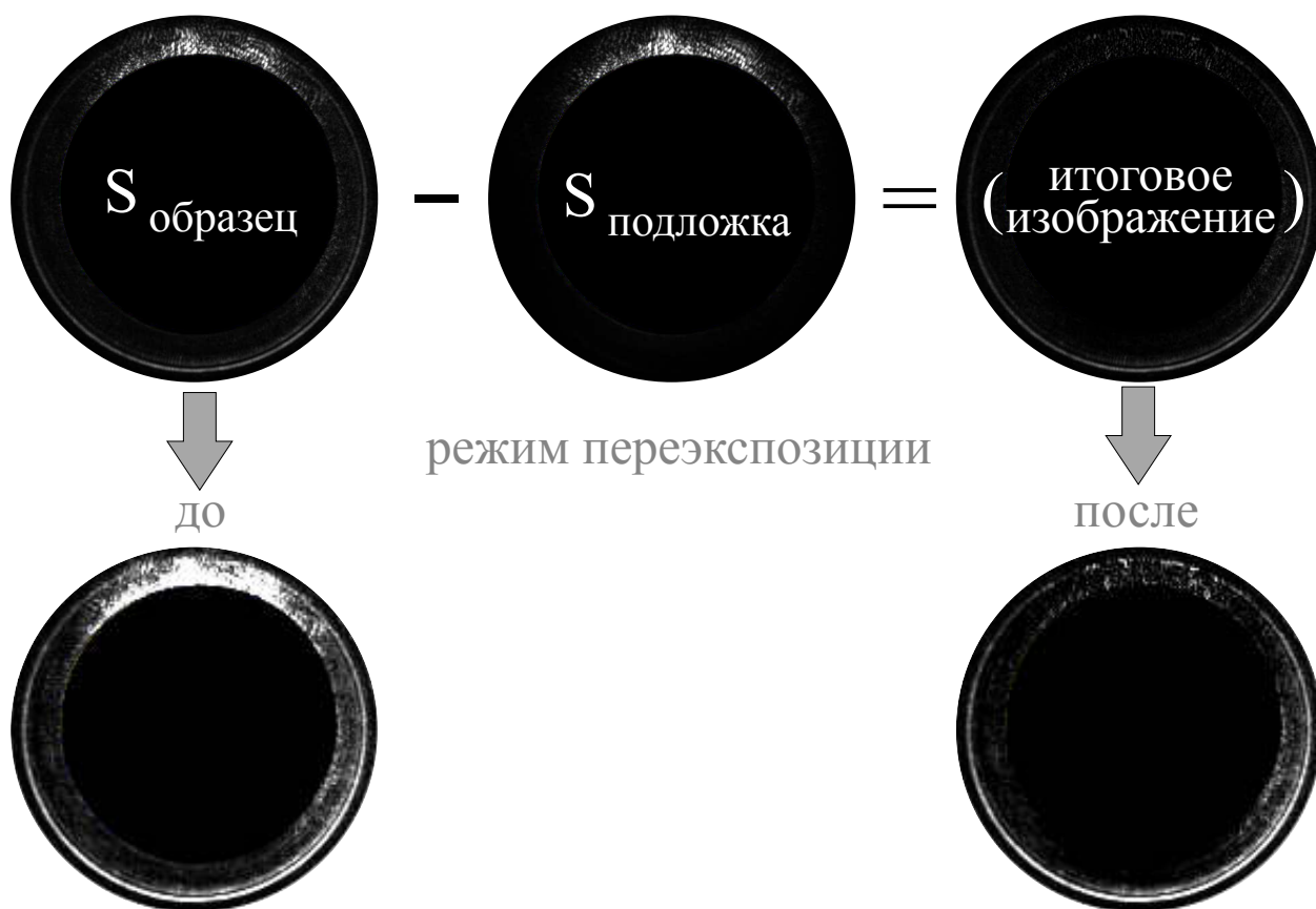
Рис. II.12: Программная обработка получаемых изображений методом вычитания. Результат представлен для образца НЧ4 и длины волны излучения 720 нм. Внизу показаны изображения ЗФП в режиме переэкспозиции до и после обработки.
