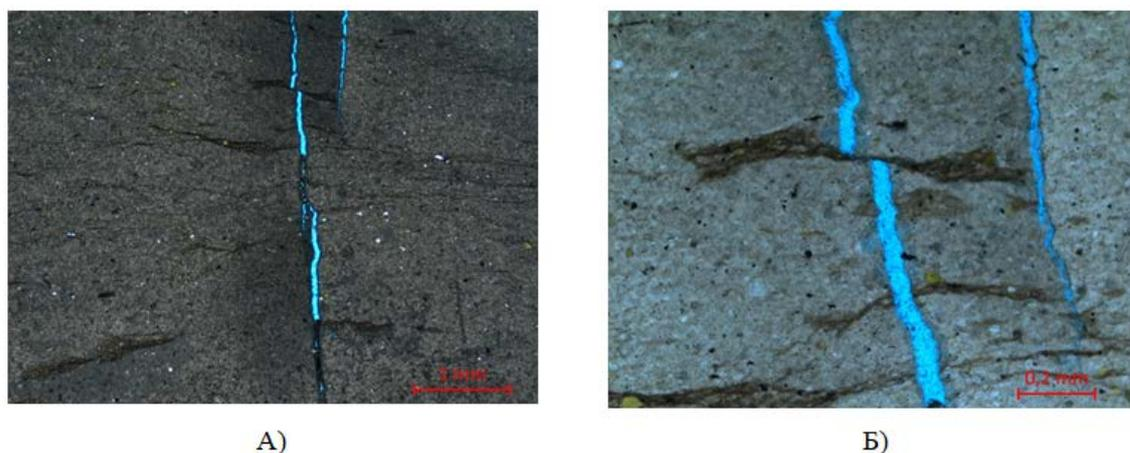
Рисунок 7.12. (А) (А, Б) Вертикальный срез. Николи параллельны. Клиновидные, кулисообразные, ветвящиеся трещины синерезиса в опоке. Участками (А) трещины заполнены кремнисто-глинистым веществом, единично по стенкам пирит, основная часть трещин открыта, пропитана эпоксидной смолой голубого цвета. (ООО «ТННЦ»).
