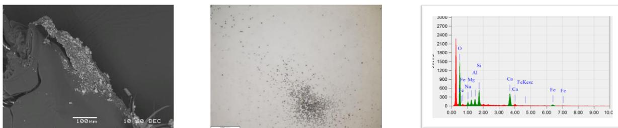
Рисунок 10. Электронная микроскопия, альфа-трековая радиография и элементный анализ частички, прилипшей к телу хирономиды
