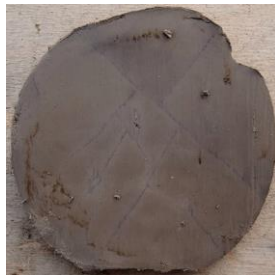
Рис. 4. Скважина R1, 26.9 м. Трещины усыхания в ательских отложениях.
