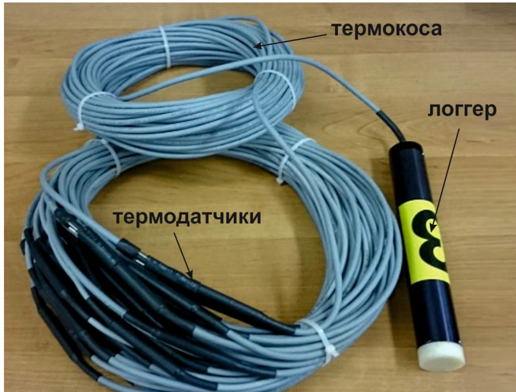
Рис. 2.58. Коса цифровая термометрическая с возможностью передачи данных по радиоканалу до 500 м на акватории.
