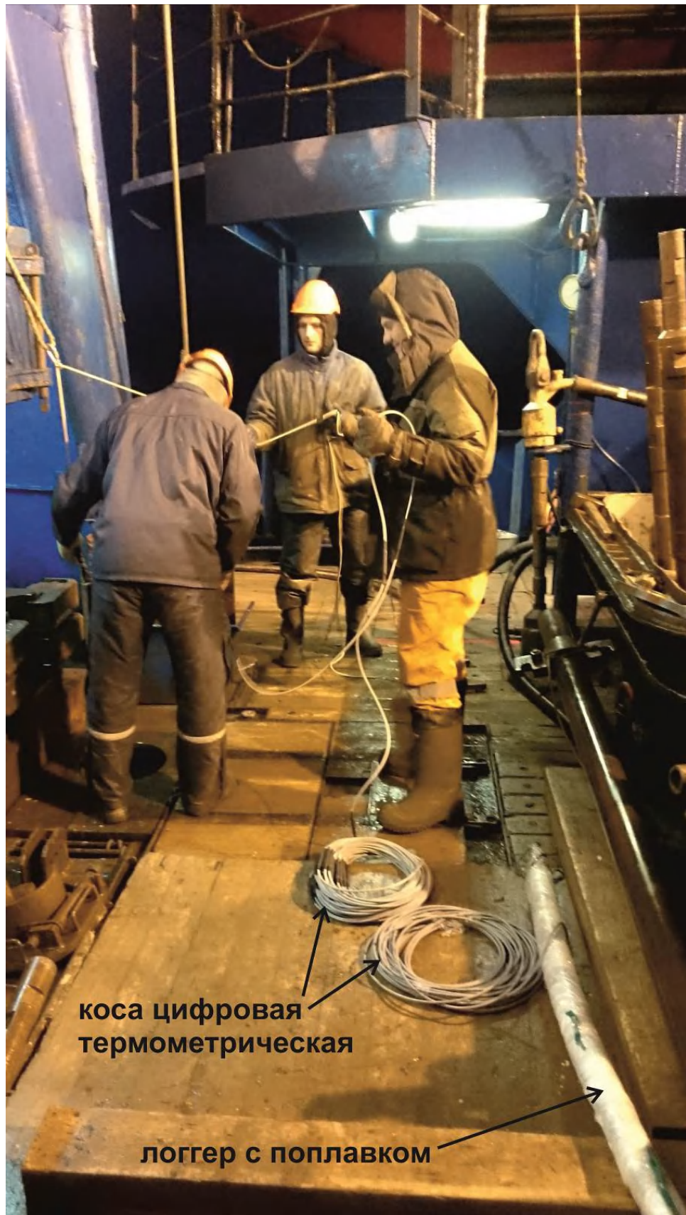
Рис.2.60. Установка термокосы в скважину на шельфе, НИС «Кимберлит». Пряймальский шельф 2016 г.
