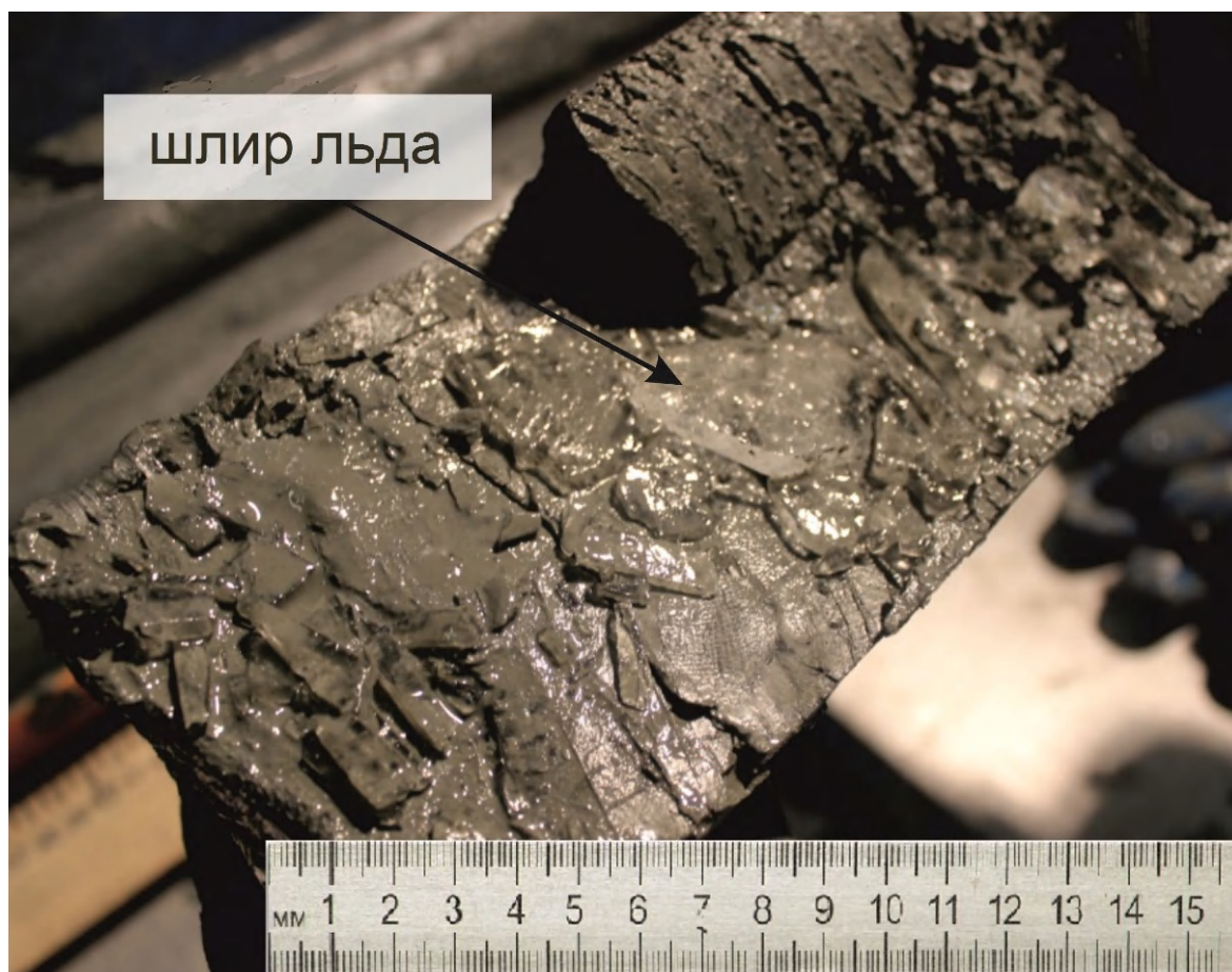
Рис. 2.55. Вертикальный шлир льда в керне из скважины на детальных площадках приямальского шельфа.
