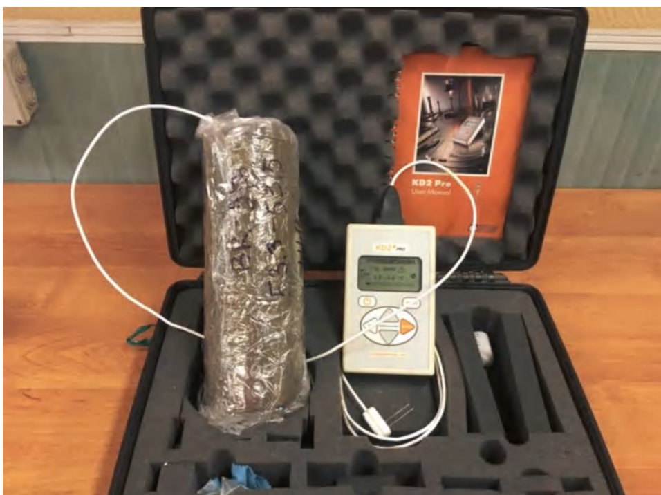
Рис. 2.9. Определение теплопроводности в полевых условиях.
