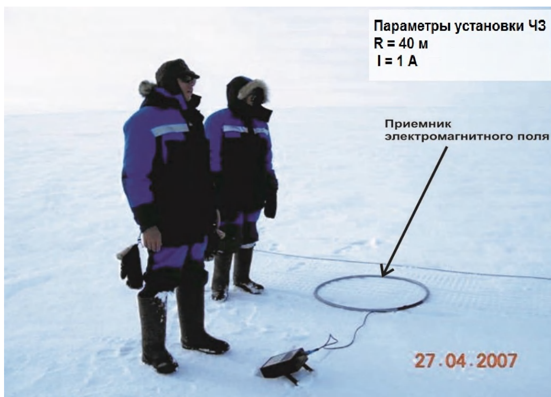
Рис. 2.28. Работы методом ЧЗ на льду Байдарацкой губы Карское море, 2007г.
