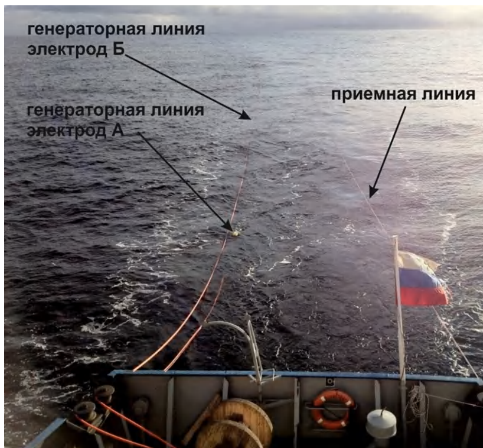
Рис. 2.24. Работы методом ЗСБ на шельфе моря Лаптевых, НИС «Виктор Буйницкий», 2012 г.
