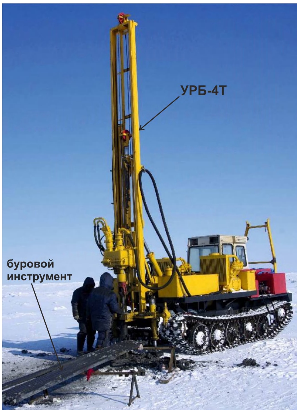
Рис. 2.63. Бурение со льда, шельф моря Лаптевых. Работы по гранту РФФИ.
