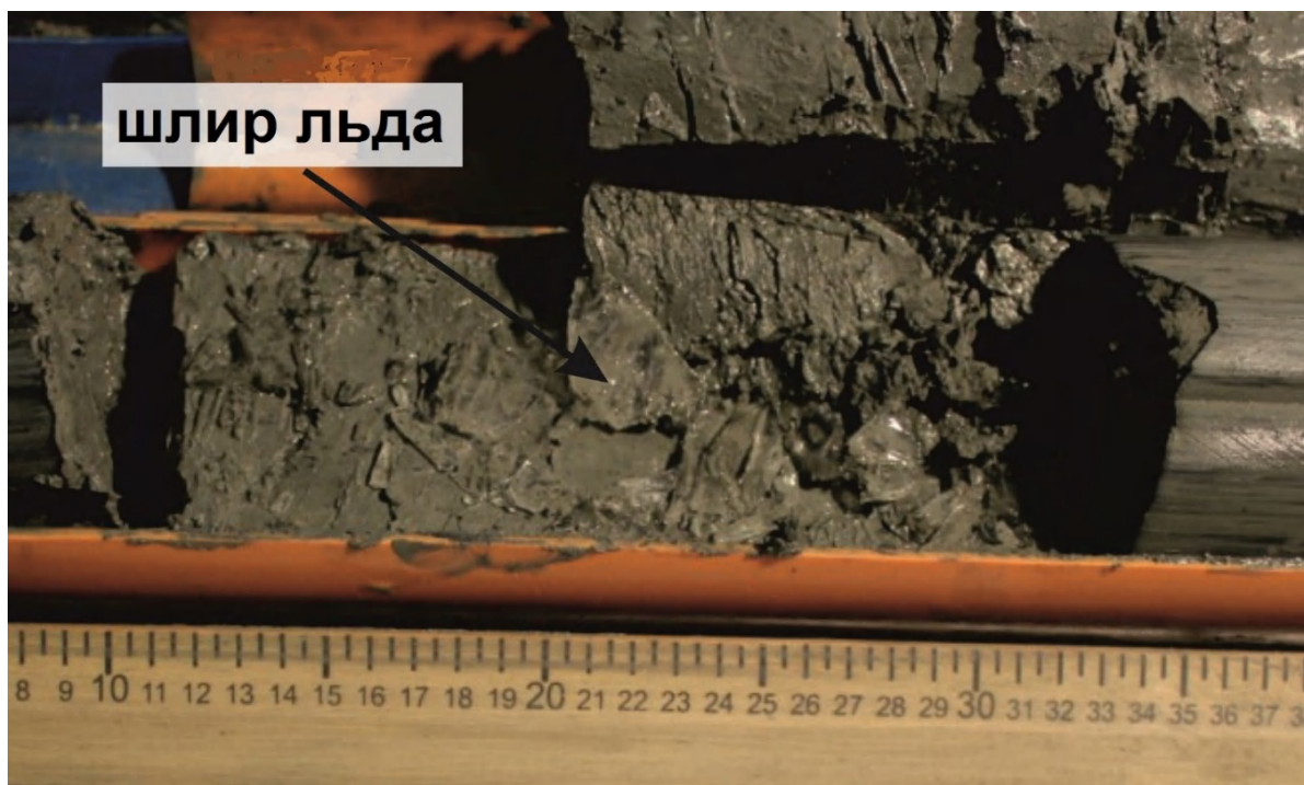
Рис. 2.54. Откол керна по вертикальным шлирам льда.
