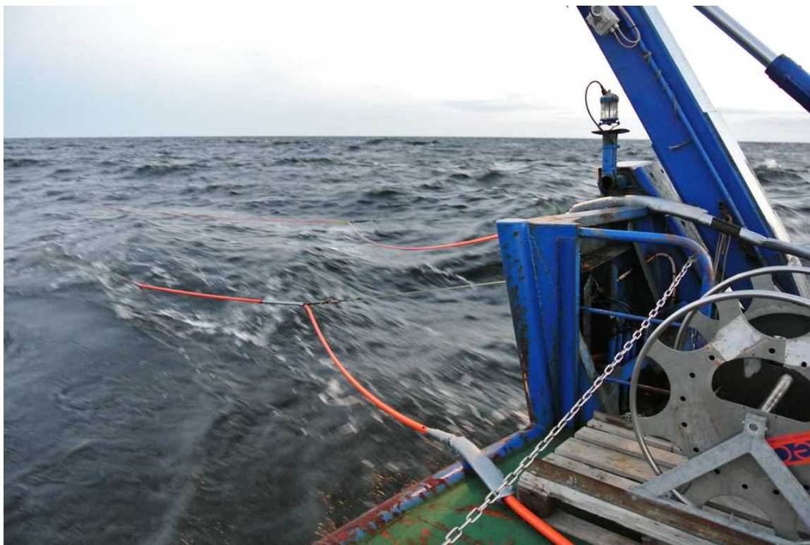
Рис. 2.39. Буксировка сейсмоакустических устройств.
