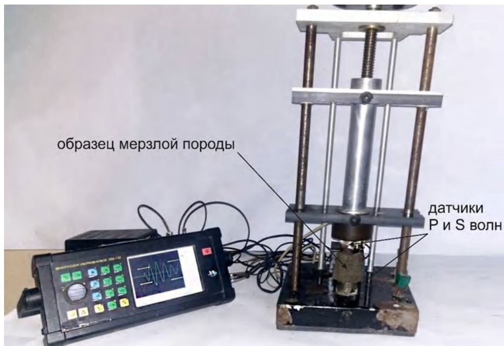
Рис. 2.5. Образец породы, размещенный в сейсмоакустической установке.
