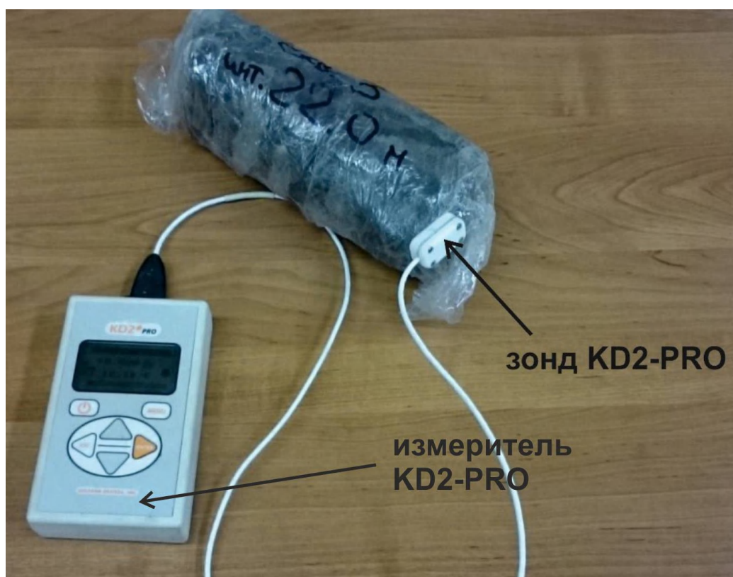
Рис. 2.57. Процедура определения теплопроводности грунта прибором KD2-PRO.
