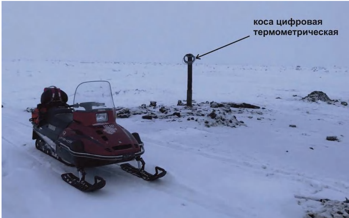
Рис. 2.64. Термометрия в скважине с припайного льда Хатангского залива. Шельф моря Лаптевых, 2017 г.
