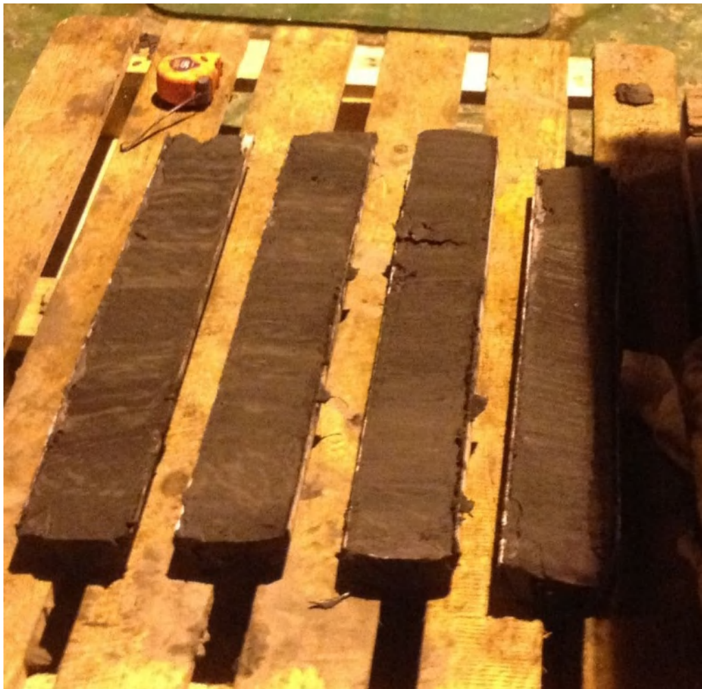
Рис. 2.50. Керн, отобранный вибростанком.
