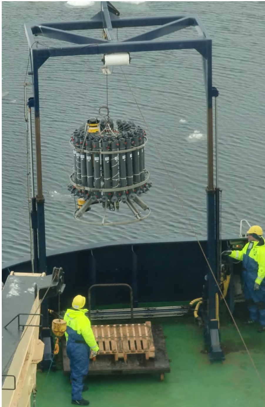
Рис. 2.47. Комплекс батометров для отбора проб воды, экспедиция SWERUS-C3, 2014 г.
