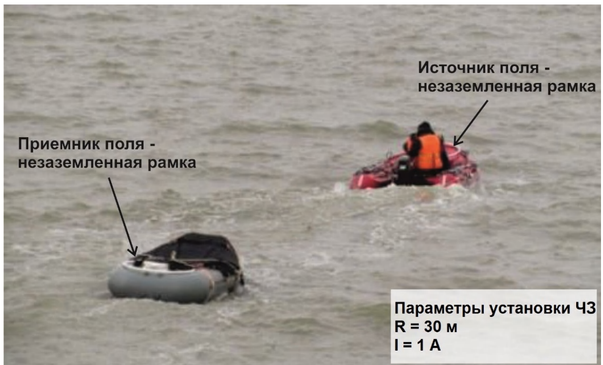
Рис. 2.27. Работы методом ЧЗ в заливе Шарапов Шар Карское море, 2010 г.
