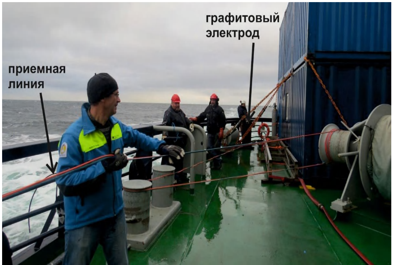
Рис. 2.25. Работы методом ЗСБ на шельфе Чукотского моря, Ледокол «Оден», 2014 г.
