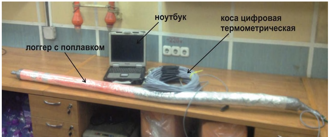
Рис. 2.59. Комплект для термометрии на шельфе Карского моря на борту НИС «Кимберлит».
