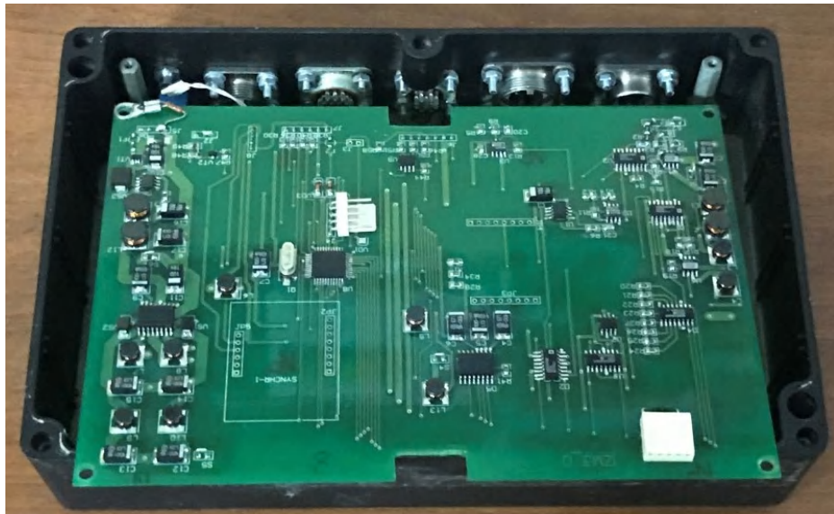
Рис. 2.20. Единая измерительная плата аппаратного комплекса ЗСБ Цикл-7. Изготовитель ООО «НТФ Эльта-Гео».
