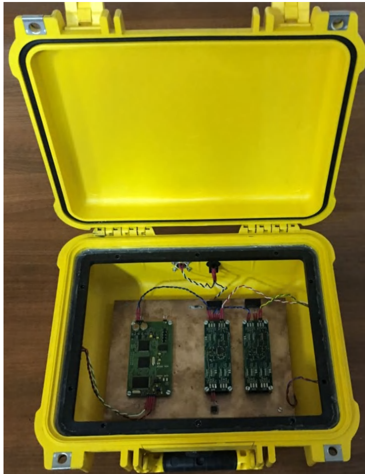
Рис. 2.21. Три разнесенных измерительных канала аппаратного комплекса ЗСБ «ТЕЛСС-3-Э». Изготовитель ООО «Геосигнал».
