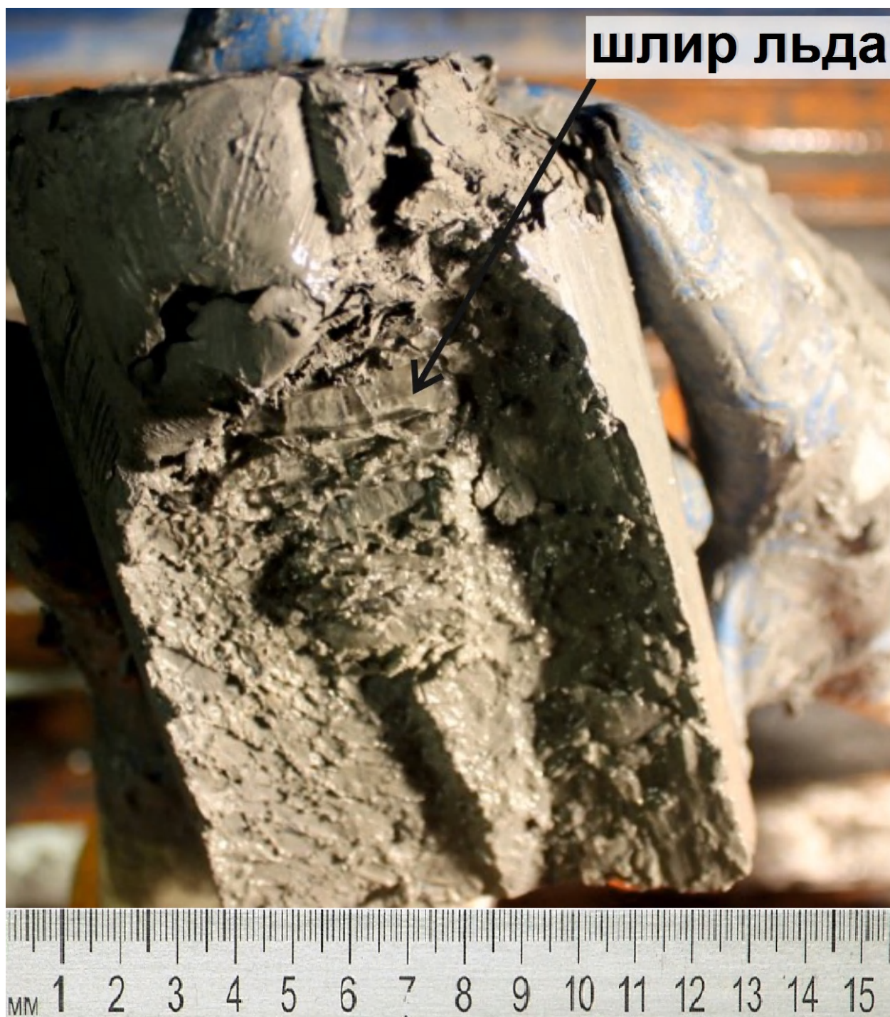
Рис. 2.53. Горизонтальные шлиры льда в керне из скважины на детальном площадке приямельского шельфа.
