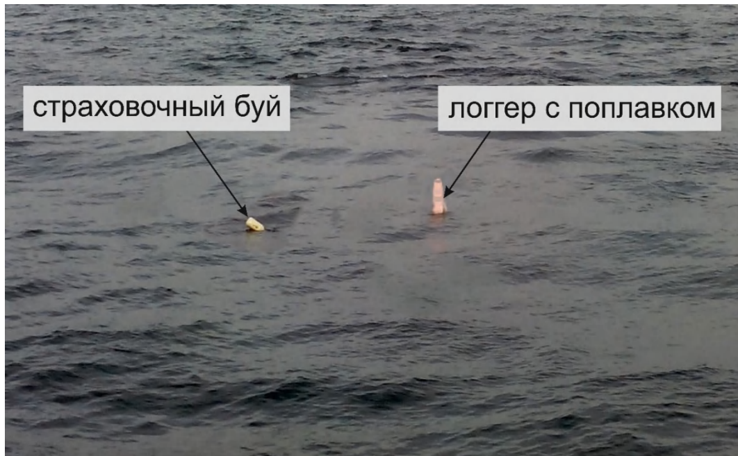
Рис. 2.61. Радио-логгер на поверхности акватории Карского моря, 2016 г.
