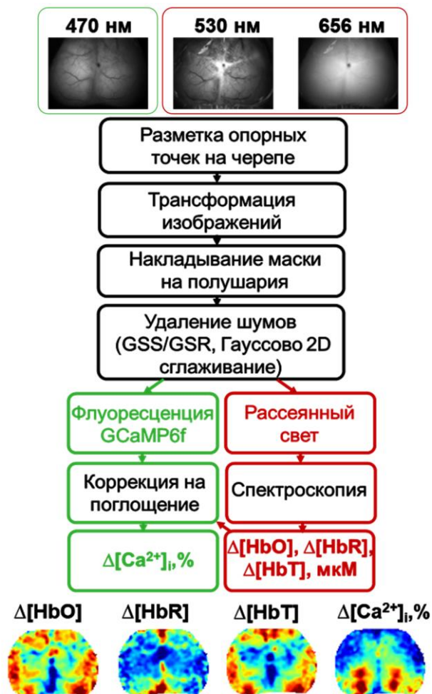
Рис. 1. Схема основных этапов работы «Программы для автоматизации выделения физиологически значимых сигналов из данных широкопольной оптической нейровизуализации».
