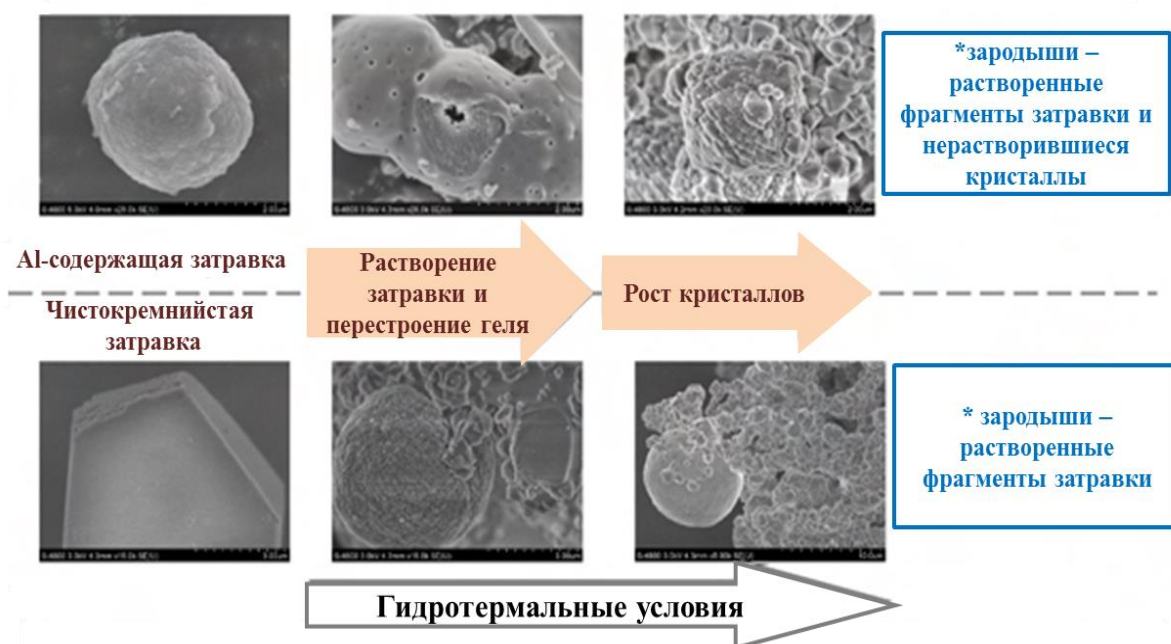
Рисунок 1.22 – Предполагаемый механизм действия кристаллической затравки в бестемплатном синтезе цеолитов ВЕА методом ГТК [39]
