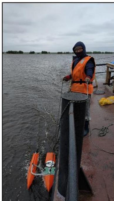
Рисунок 3.2.3 – ADCP RiverSurveyor M9 «RiverRay» в рабочем состоянии
