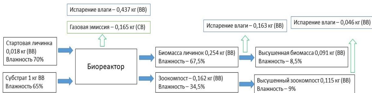
Рисунок 9. Схема процесса биоконверсии субстрата на основе комбикорма для цыплят бройлеров с балансом масс.
