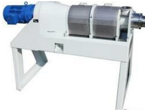
Рисунок 58. Маслопресс для концентрации протеина и обезжиривания продукции.
