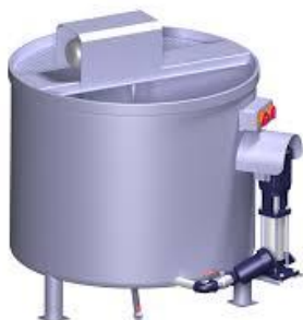
Рисунок 50. Оборудование для измельчения компонентов кормовых субстратов
