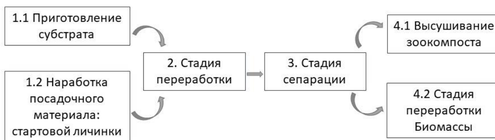
Рисунок 6. Общая технологическая схема процесса биоконверсии органических субстратов личинками H. illucens .
