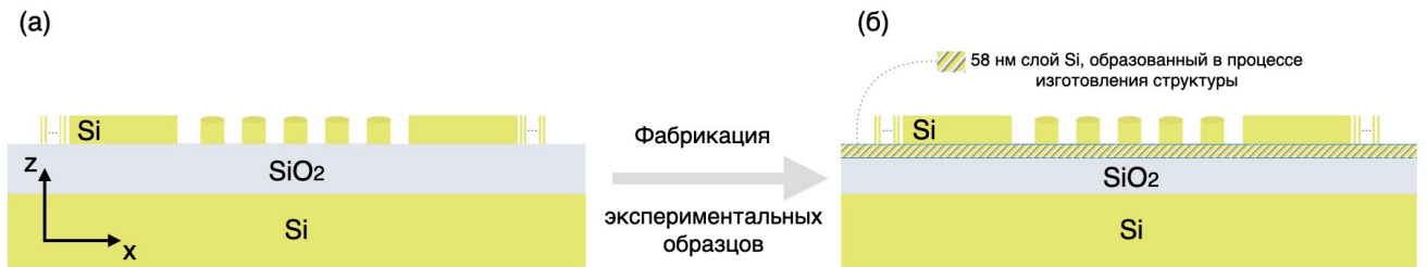
Рис. 58: Схематические изображения РВС (а) расчетной модели и (б) изготовленного экспериментального образца.
