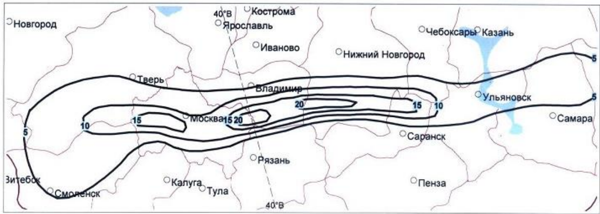
Рисунок – 1.3. Максимальные значения толщины гололедных отложений (мм) за период 24-28.12.2010 г. [Голубев и др., 2013]
