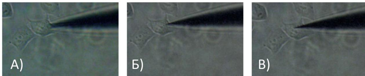
Рис. 38. Позиционирование нанозэлектрода над клеткой на значительном расстоянии (А), непосредственно у поверхности клетки (Б); внутри клетки(В)
