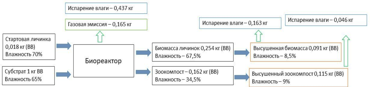
Рисунок 17. Баланс масс при переработке 1 кг комбикорма.
