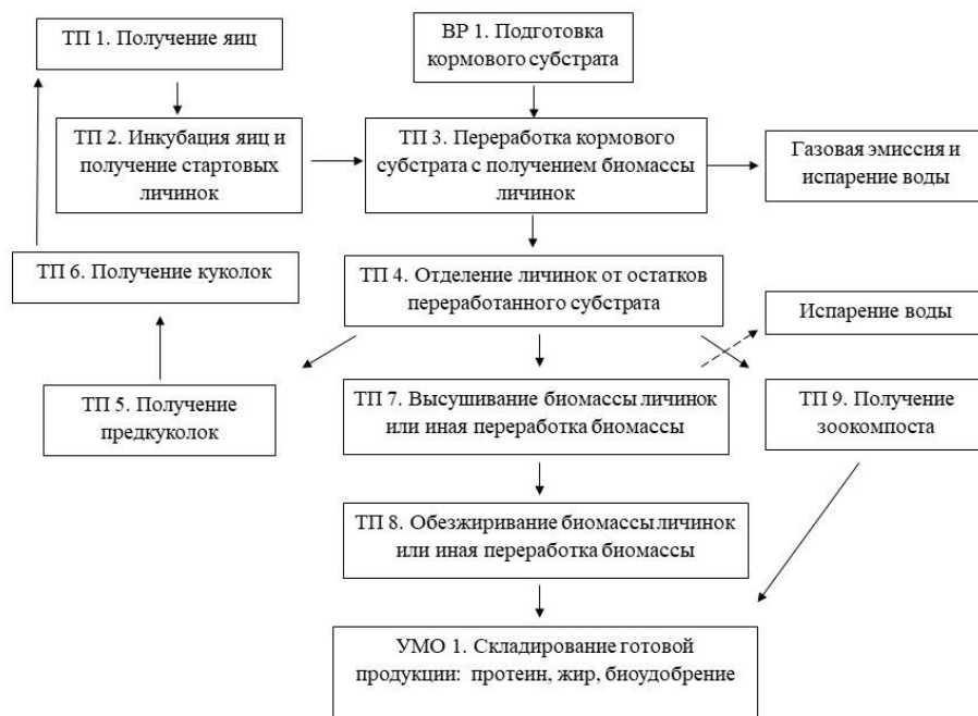
Рисунок 21. Технологическая схема биоконверсии органических субстратов и производства биомассы личинок H. illucens .
