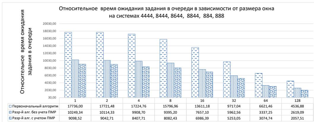
Рисунок 5.27 — Среднее относительное время ожидания по всем большим системам от 256 до 1024 узлов в зависимости от размера окна.
