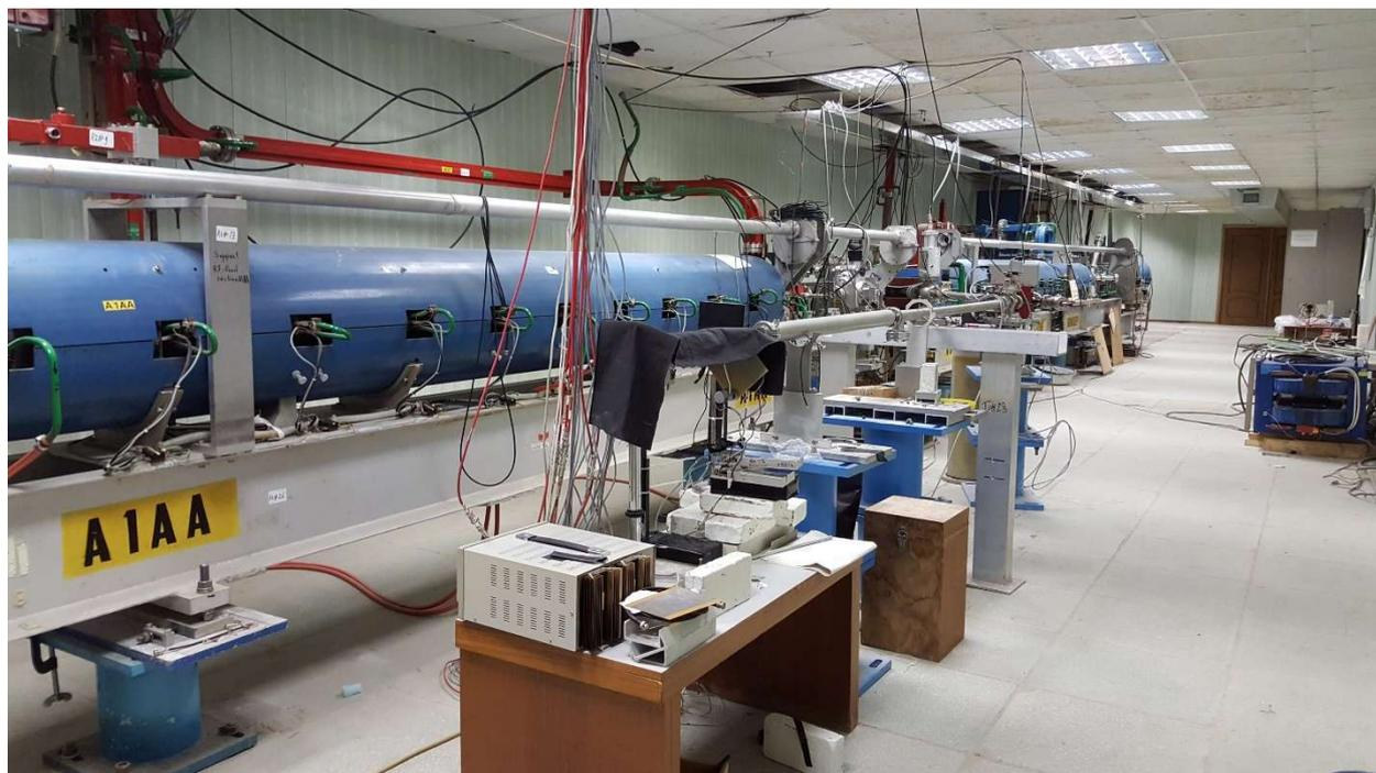
*Рисунок 26. Ускорительная секция электронного ускорителя ЛИНАК-200.*
