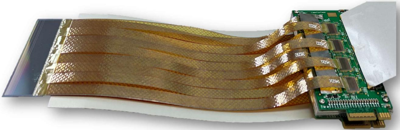
*Рисунок 24. Полный детекторный модуль со снятым экраном.*
