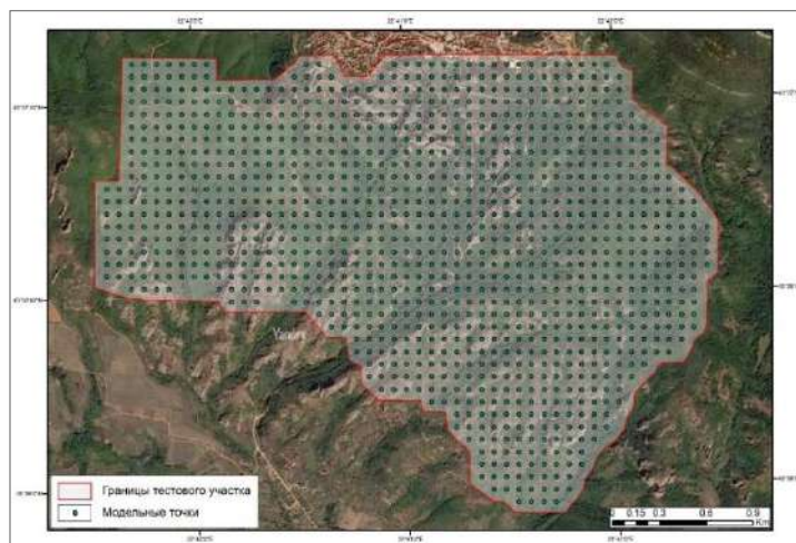
Рис. 4.1. Регулярная сетка с модельными точками обзора в пределах территории исследования
