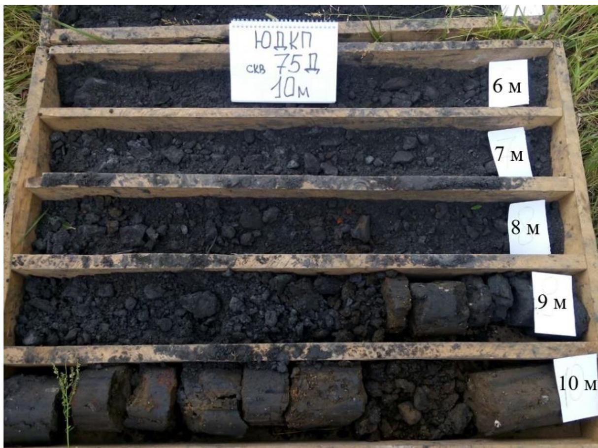
Рисунок 2.5. Керн скважины 75Д, расположенной в юго-восточной части золоотвала, в интервале глубин 6-10 м (фото К.А. Дарменко)
