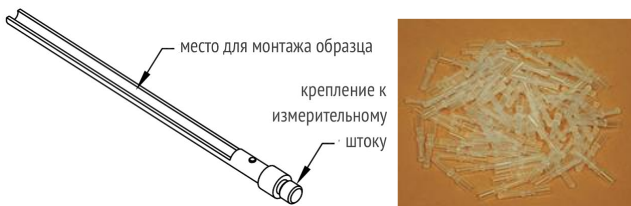
Рис. 2.3. Держатель образцов в форме желоба (слева) и тефлоновые капсулы для порошковых образцов [82].
