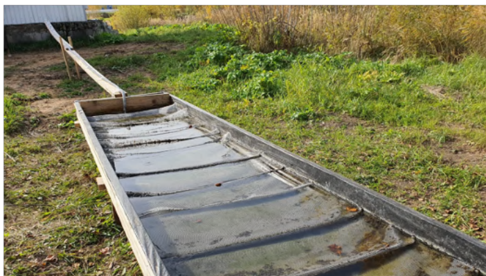
Рис. 9. Внешний вид установки проточного жёлоба, в которую подаётся сточная вода после ступени доочистки.
