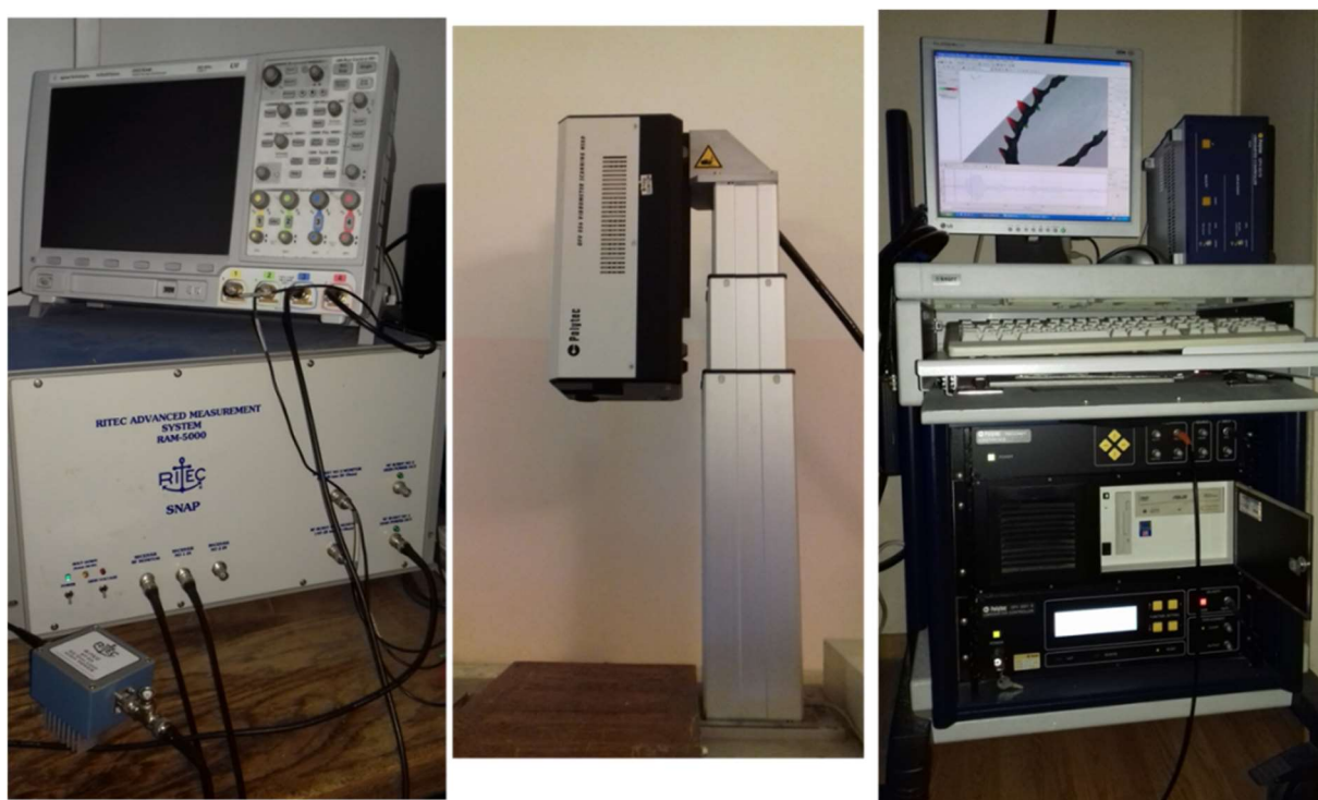
Рис. 2.1.2. Фотография экспериментальной установки: а) Ультразвуковой измерительный комплекс Ritec RAM-5000 SNAP SYSTEM и цифровой осциллограф DS09104A, б) головка сканирующего лазерного виброметра, в) персональный компьютер и блок лазерного виброметра.
