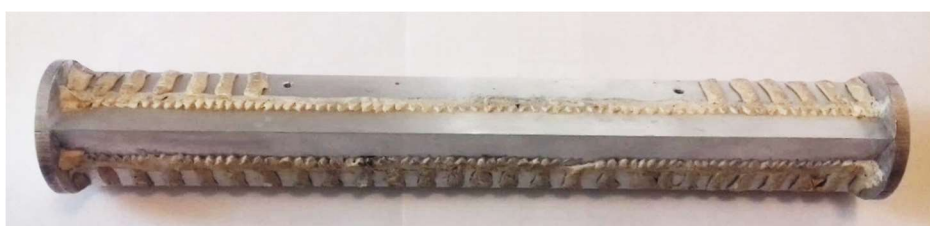
Рис. 2.2.1 Изотропный дюралюминиевый клин с углом раскрыва 60^\circ .
