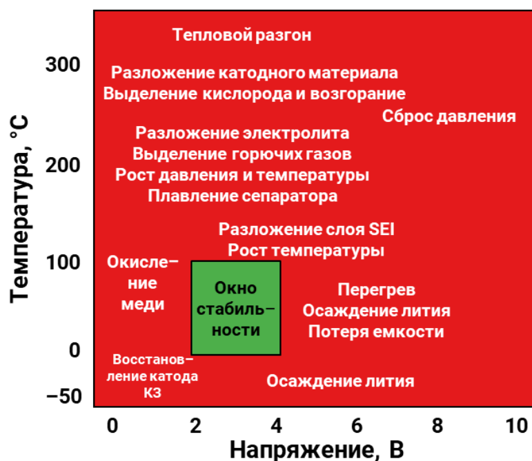
Рисунок 2 – Рабочее «окно стабильности» литий-ионной ячейки в координатах «температура – напряжение» [28]
