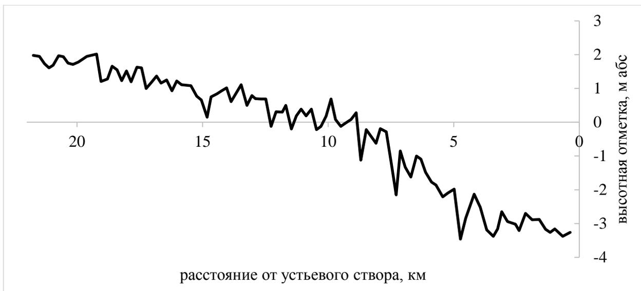
Рисунок 2.8 – Продольный профиль дна русла устьевого участка Сёмжи по измерениям 2015 и 2018 гг.
