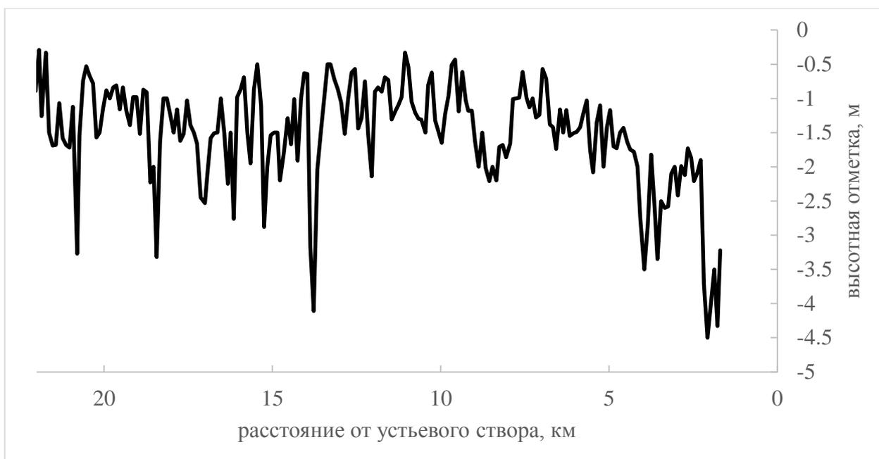
Рисунок 2.16 – Продольный профиль дна русла устьевого участка Лаи по измерениям 2019 г.
