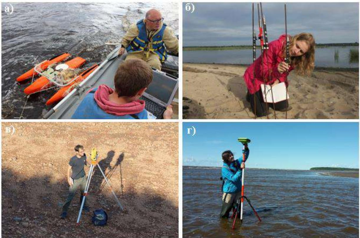
Рисунок 2.7 – Работа с приборами: а) измерения расходов воды с помощью акустического доплеровского профилографа течений RiverRay; б) подготовка логгеров для измерения уровней воды; в) работа с тахеометром; г) работа с DGPS-приемником Javad (фото автора и Л. Одоева).
