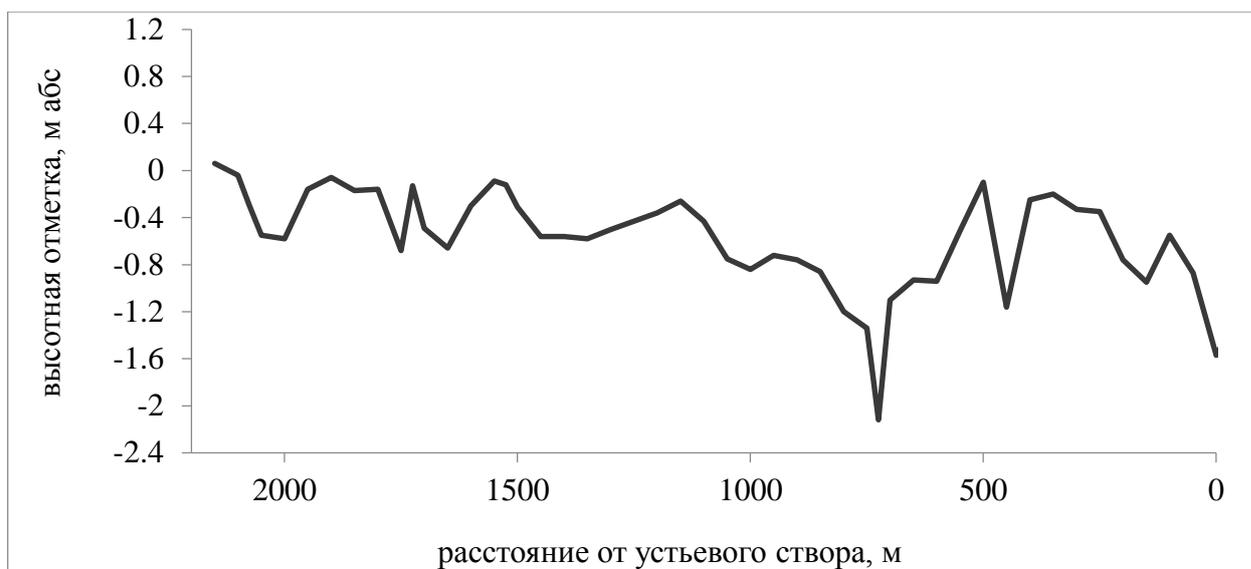
Рисунок 2.14 – Продольный профиль дна русла устьевого участка Тамицы по измерениям 2016 г.
