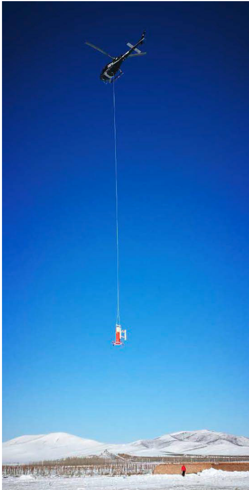
Рисунок 2.4 — Проведение натурных экспериментальных измерений (см. работу [9]) компонент тензора градиентов компонент магнитной индукции на разных высотах над поверхностью Земли с помощью сенсора SQUID. Траектория движения сенсора может представлять достаточно произвольную кривую.
