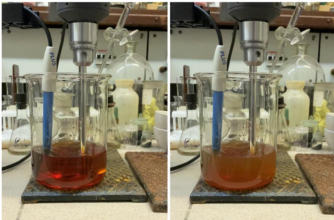
Рисунок 2.1 — Фотография коллоидного раствора во время покрытия при кислотности среды от 2,7 до 3 (слева). Помутнение при переходе через изоэлектрическую точку в конце процедуры покрытия (справа).
