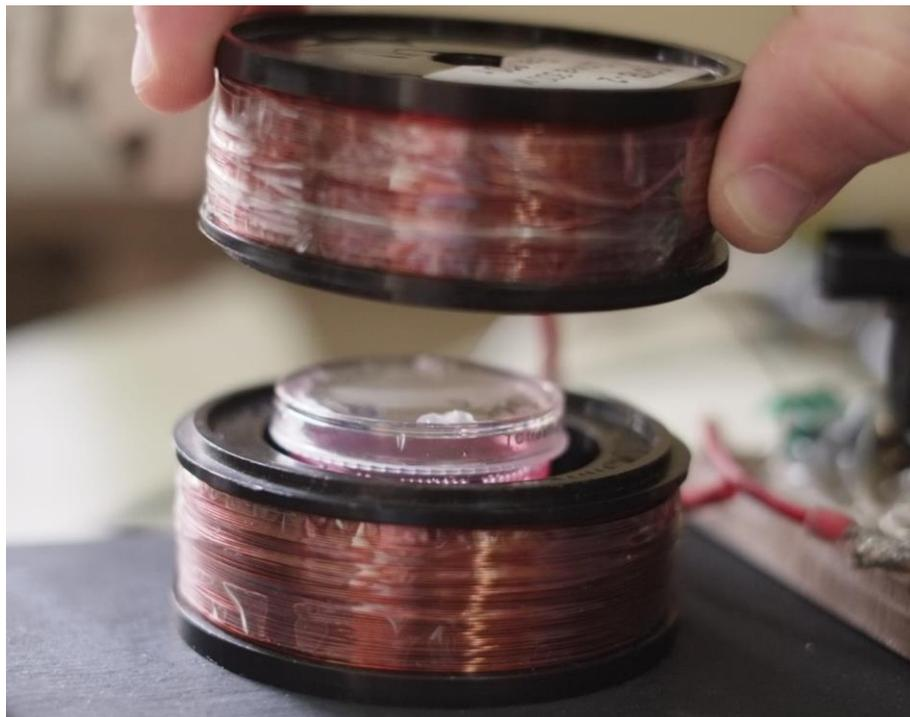
Рисунок 3.37 — Фотография установки для экспериментального проведения магнитомеханической терапии на клеточных культурах.
