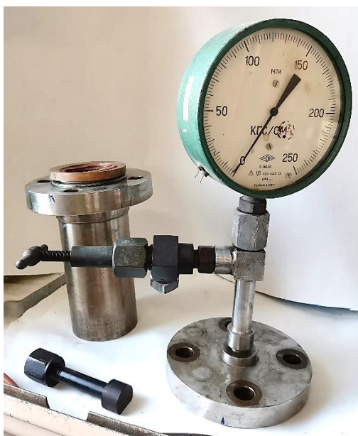
Рисунок 46 - Автоклав для синтеза пентакарбонилгалогенидных комплексов технеция и рения
