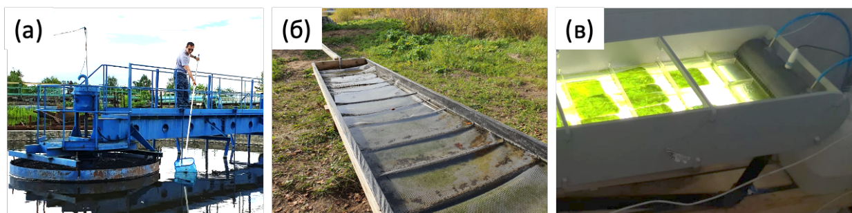
Рис. 2. Сбор АБС активного ила на водоочистных сооружениях Звенигородского водоканала: сбор активного ила из вторичных отстойников (а), внешний вид установки проточного желоба, в которую подаётся сточная вода после третичной очистки (б), внешний вид установки тонкослойного каскада с иммобилизованной культурой Micractinium simplicissimum IPPAS C-2056.
