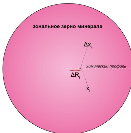
Рис. 5.1. Схематическое изображение зерна зонального минерала с обозначением компонент интегрального состава (расшифровано слева) в сферическом приближении.
