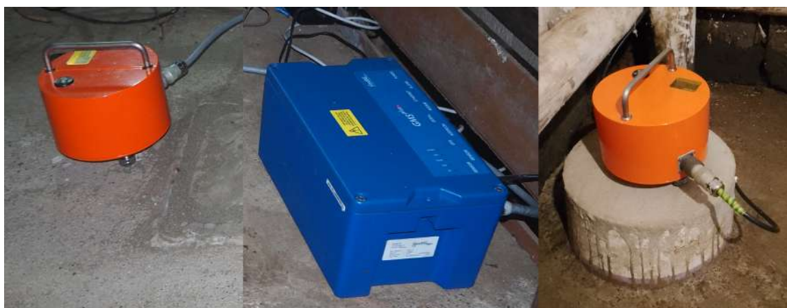
Рисунок 4.5. Сейсмометры СПВ-3к, установленные на сейсмической станции «Углегорск» (слева) и АПИН UGL4 (справа) и регистратор GeoSIGGMS-18
