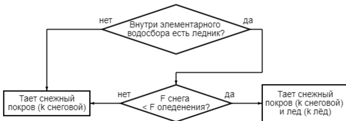
Рисунок 2 – Блок-схема работы ледникового блока модели ЕСОМАГ ( k_{\text{снег}} – коэффициент таяния снега, k_{\text{лед}} – коэффициент таяния льда)
